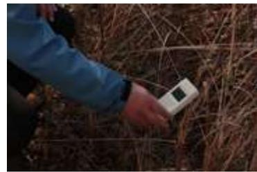
線量計での放射線量測定
